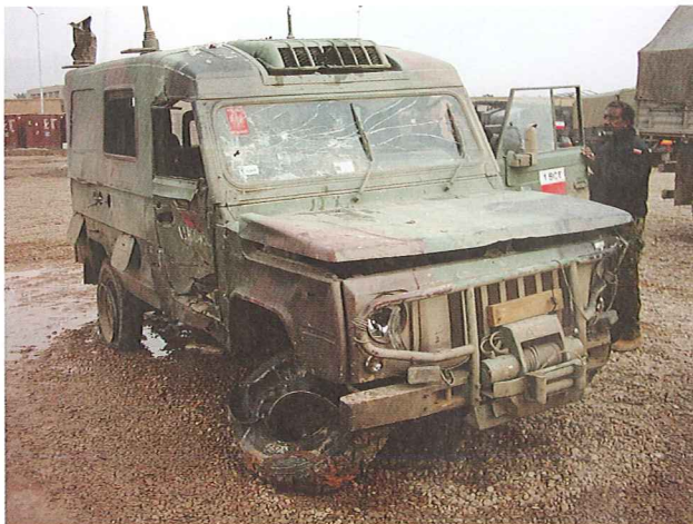
Rycina 3. Po eksplozji improvizowanego ładunku wybuchowego Figure 3. After explosion of improvised explosive device
